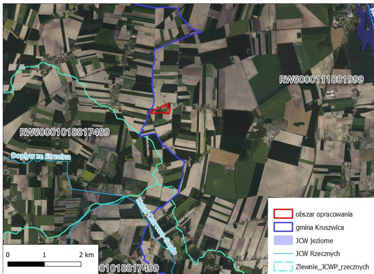
Rysunek 12. Mapa hydrologiczna z podziałem na zlewnie jednolitych części wód we fragmencie terenu Gminy Kruszwica
